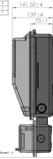
Se não especificado: Dimensões em milímetros; Tolerâncias: Linear: 2 mm; Angular: 1°.
